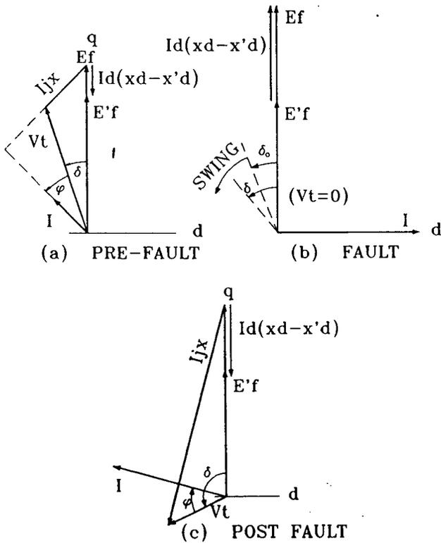
Figure 6 - Motor d-q Diagrams
